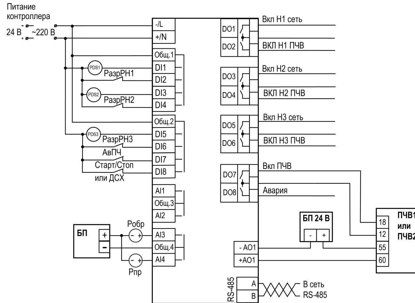
**Рисунок 5.7 – Схема подключения СУНА-122.Х.05.30**
