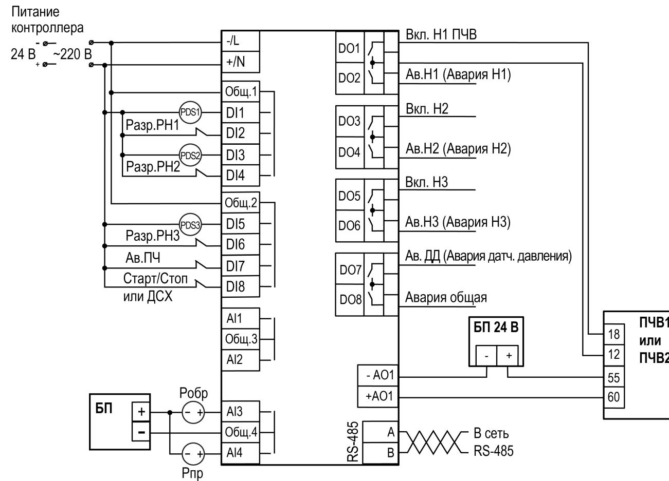
Рисунок 5.5 – Схема подключения СУНА-122.Х.05.10
