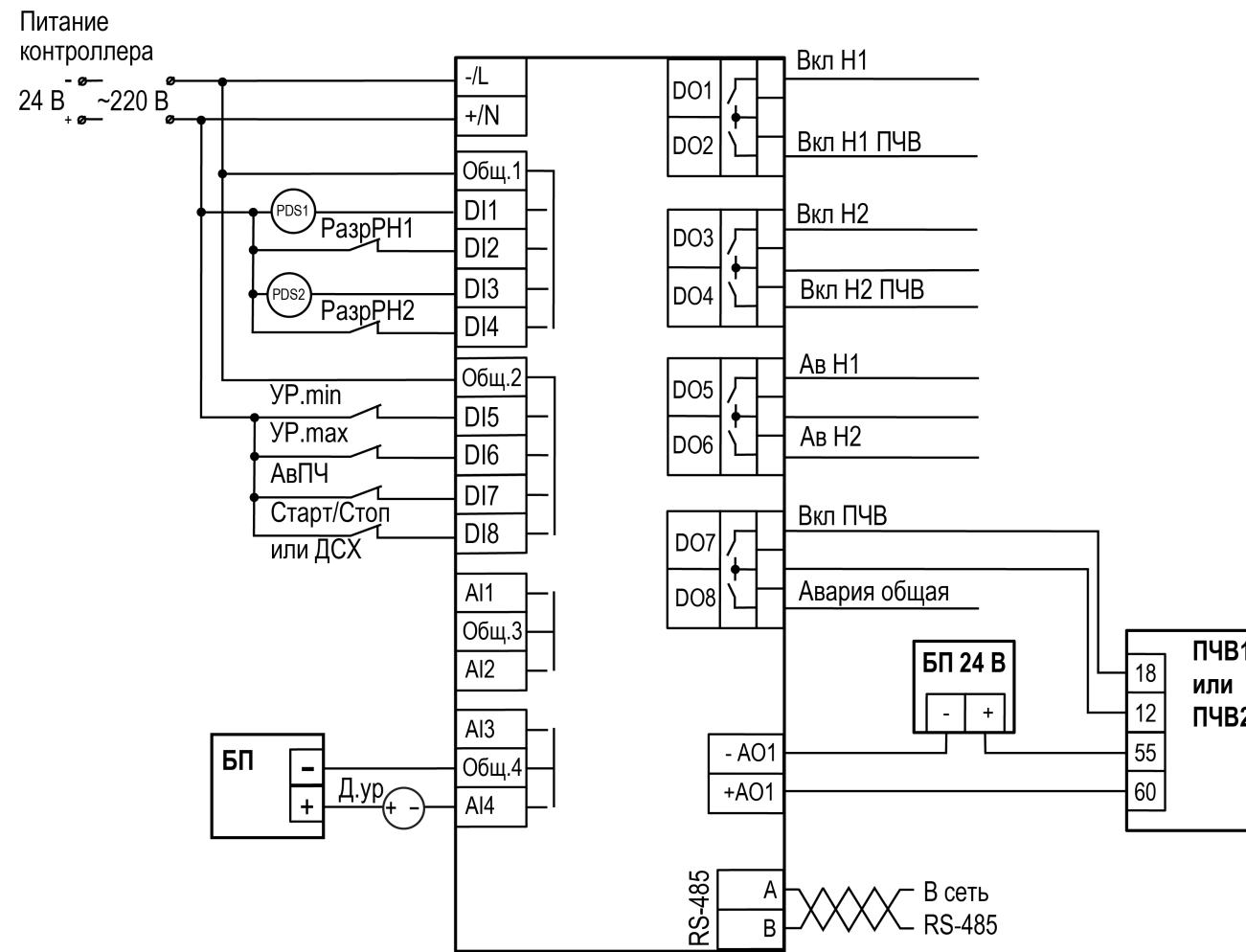
Рисунок 5.8 – Схема подключения СУНА-122.Х.07.20
